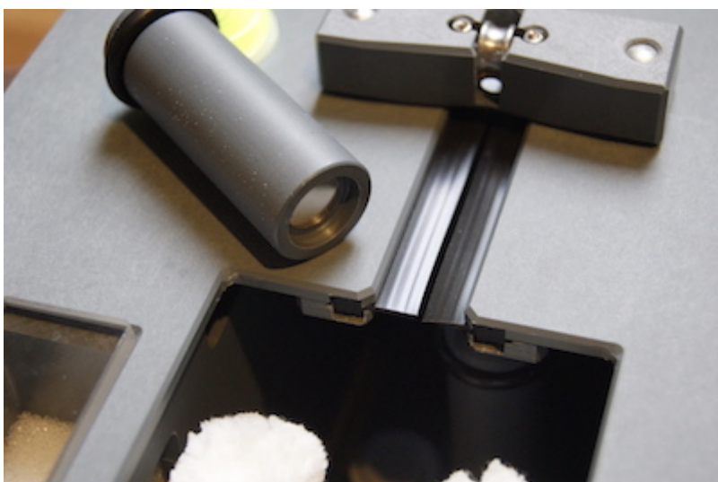
Foto 4: Antriebsrolle mit Magnet
