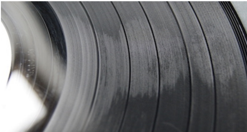
Foto 16: Öl - LP nach der ersten Reinigung
